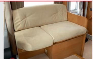
D'une position « Salon » autour d'une table, il devient possible de reconfigurer les sièges de telle façon qu'ils puissent être utilisés face route avec ceinture de sécurité lors d'un trajet routier.
